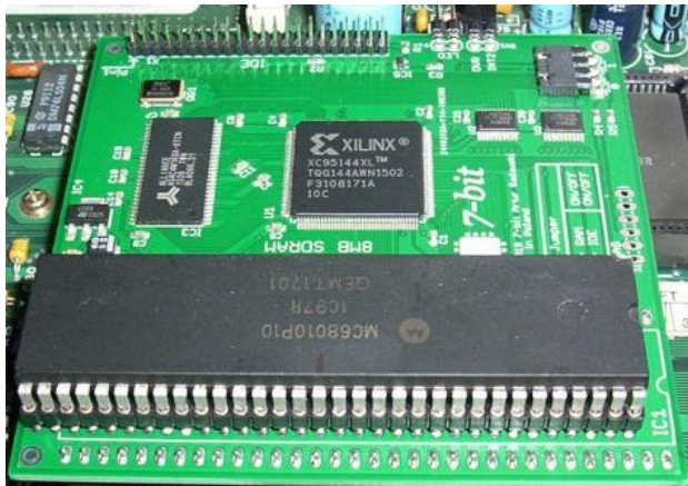
Widok prawidłowo zamontowanego mikroprocesora.
