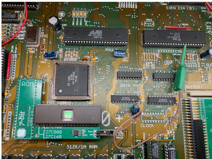
Prawidłowo zamontowany KickSwitcher w podstawce pamięci ROM w Amidze 500/500+
